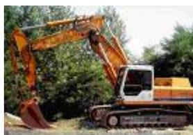
Macchina operatrice semovente su cingoli o ruote gommate, spinta da un motore endotermico diesel e dotata di un braccio articolato alla cui estremità viene montata una benna.
